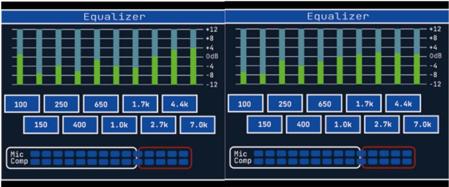
CB externe pour micro électret. Niveau de compression 5-10 dB CB DX pour micro électret. Niveau de compression 10-20 dB
